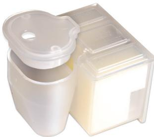
Accepte des tailles d'échantillon jusqu'à 6 ml.
